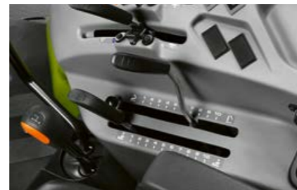
Mechanische regelventielen zijn in combinatie met een mechanische of elektronische hefinrichting verkrijgbaar.
