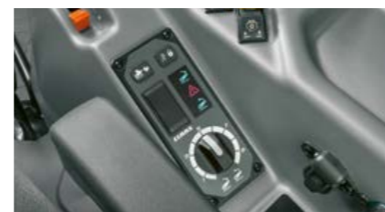
U kunt kiezen tussen de elektronische of mechanische regeling van de hefinrichting achter. Beide zijn zeer ergonomisch geplaatst rechts naast de bestuurdersstoel.
