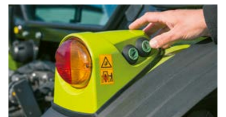
Zowel de elektronische en ook de mechanische hefinrichting kan extern worden bediend voor het aankoppelen van werktuigen.
