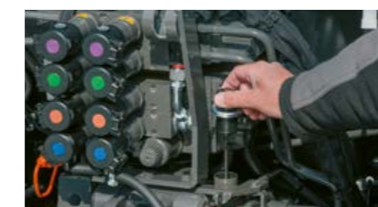
Het niveau van de transmissie- en hydrauliekolie wordt gecontroleerd met een peilstok aan de achterzijde.
