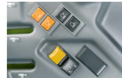
Aftakaswerk kunt u met de ELIOS heel eenvoudig uitvoeren – dankzij de standaard motortoerentalgeheugens.
