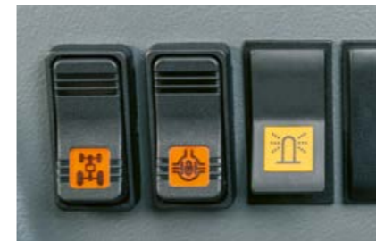
Elektronische schakeling van de vierwielaandrijving en differentieelslot: door de snelheidsafhankelijke beveiliging wordt foutieve bediening voorkomen.
