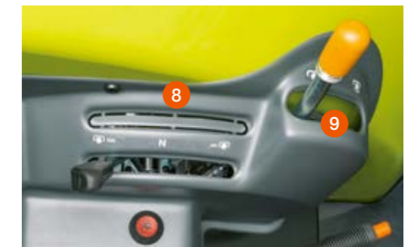
De aftakas wordt standaard hydraulisch bekrachtigd ingeschakeld. Bij machines met REVERSHIFT uitrusting is een elektronisch geschakelde aftakas achter als optie leverbaar.
