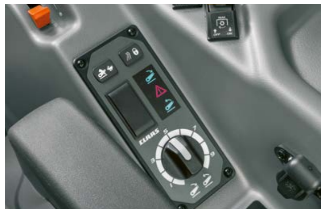
Bedieningspaneel van de elektronische hefinrichting: snel heffen, zakken en snel intrekken. Met de draaiknop wordt de werkdiepte ingesteld.
