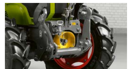
De optionele frontheif met 2,8 t hefvermogen en de frontaftakas vergroten de gebruiksmogelijkheden van de ELIOS.
